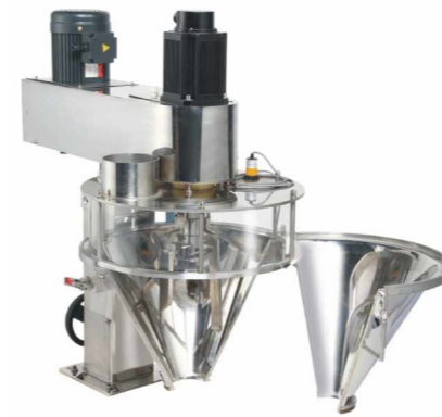
水平门开启 LEVEL DOOR OPEN
